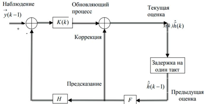
Рисунок 1 – «Структурная схема дискретного алгоритма оценки фильтра Калмана-Бьюси»
