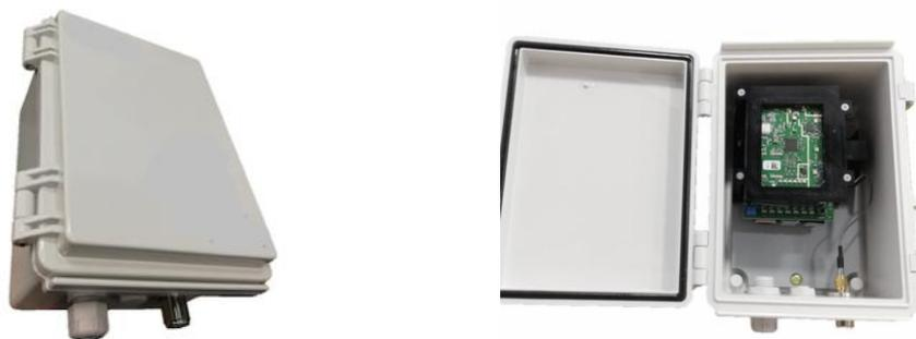
Рисунок 2 – Базовая станция LoRa
