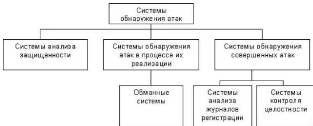
Рис. 2 – Подсистема обнаружения атак автоматизированной системы безопасности
