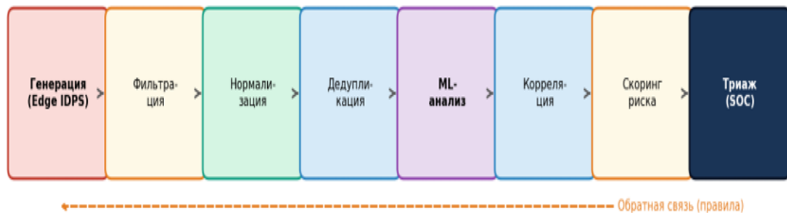
Рис. 2. Конвейер обработки событий: сбор → фильтрация → нормализация → дедупликация → ML-анализ → корреляция → скоринг → триаж
