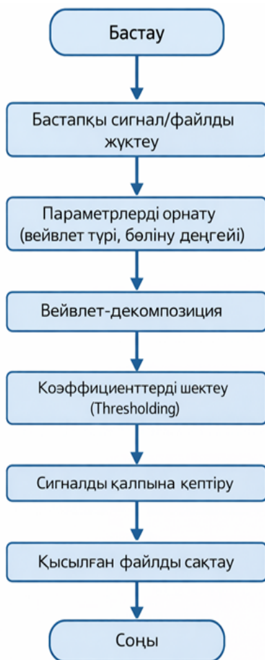
Сур. 1. Вейвлет-түрлендіргіш негізіндегі мәліметтерді қысу алгоритмінің блок-схемасы
